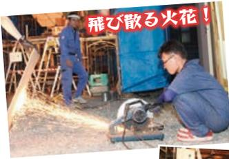
◁電動カッターで鉄筋をカット！
