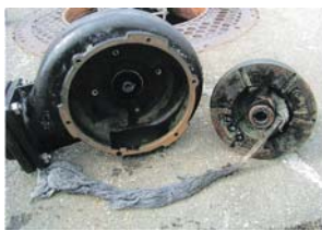
▶タオルが引っかかり、停止したポンプ
